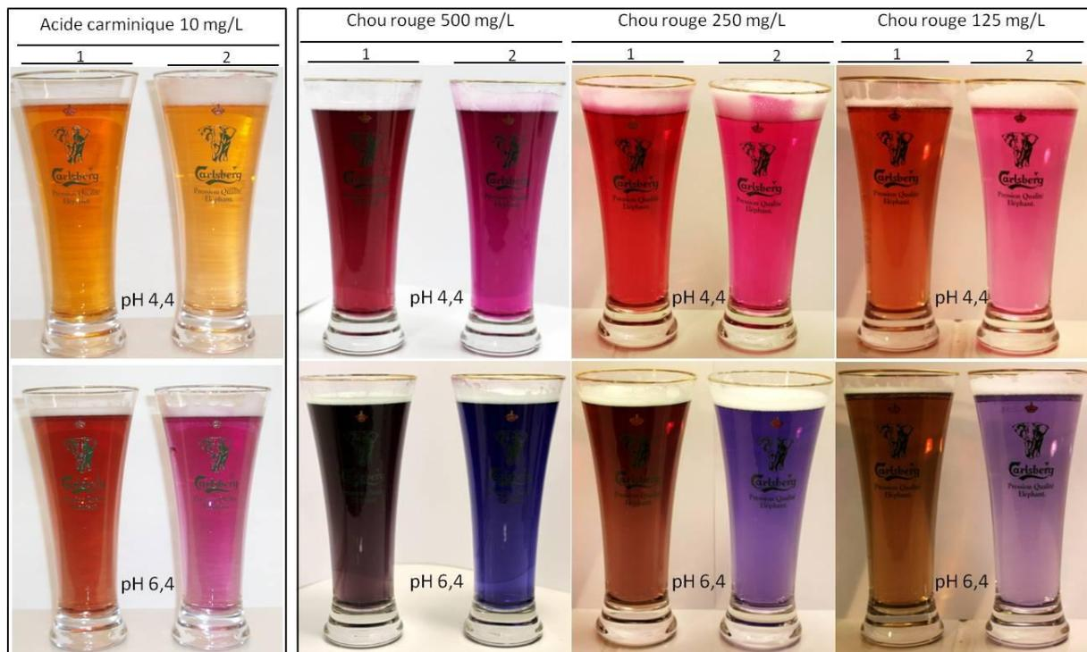
**Figure 4.12** : Coloration, en fonction du pH, de la bière (1) et de la bière décolorée (2) en présence d'acide carminique à 10 mg/L et en présence de poudre de chou rouge à 500, 250 et 125 mg/L à pH 4,4 et 6,4.
